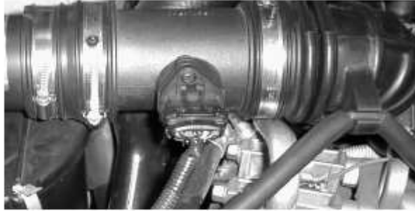
Figura 1.4 Ubicación del sensor MAF
